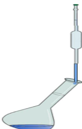
Compléter la fiole jaugée avec de l'eau distillée jusqu'au trait de jauge et agiter en retournant complètement la fiole jaugée pour homogénéiser la solution.
