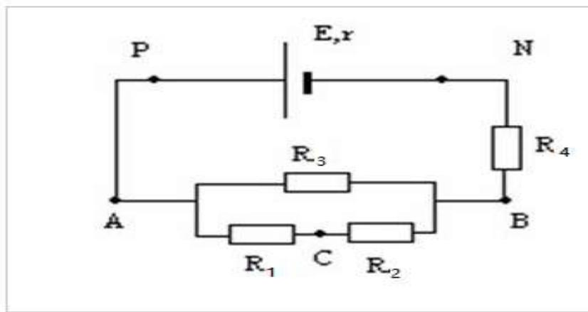
1- Calculer la résistance équivalente au dipôle AB. Représenter le dipôle équivalent.
