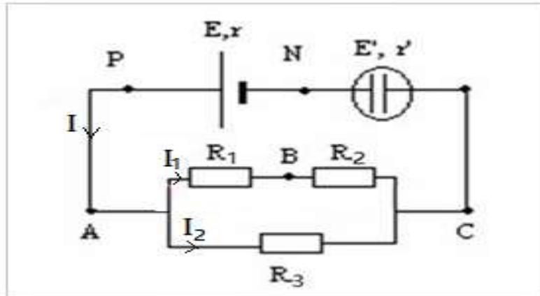
1- Calculer la résistance équivalente  $R_{eq}$  au dipôle  $AC$ .
