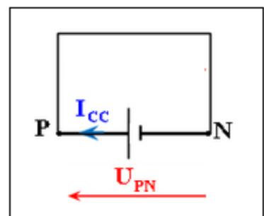
Pour mettre le générateur **en court-circuit**, on relie ses pôles par un fil métallique, dans ce cas la tension  $U_{PN}$  est nulle.
