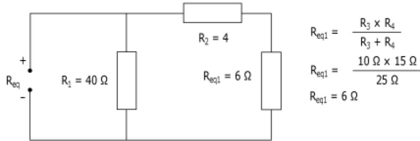
**Étape 2 :** Calcul de la résistance équivalente  $R_{eq2}$  ( $R_2$  en série avec  $R_{eq1}$ ).
