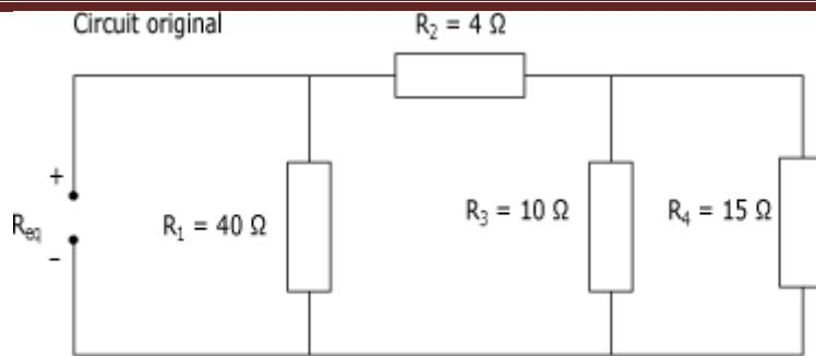
**Étape 1 :** Calcul de la résistance équivalente  $R_{eq1}$  ( $R_3$  en parallèle avec  $R_4$ ).
