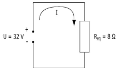
Pour déterminer la valeur du courant circulant dans le circuit, il ne reste plus qu'à appliquer la loi d'Ohm :
