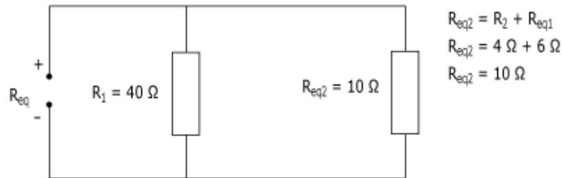
**Étape 3 :** Calcul de la résistance équivalente du circuit ( $R_1$  en parallèle avec  $R_{eq2}$ ).
