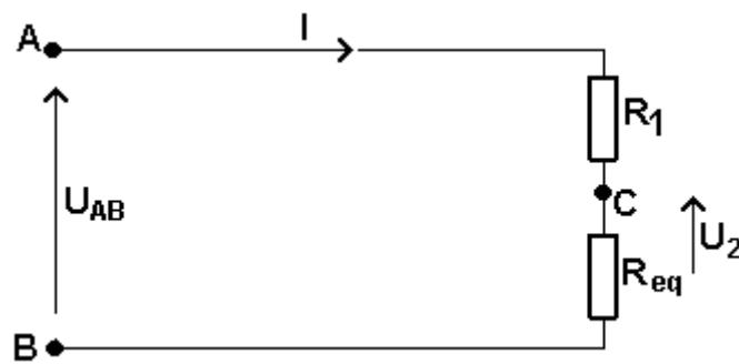
$R_1$ ,  $R_2$  et  $R_3$  ne sont pas parcourues par le même courant. Les résistances  $R_1$  et  $R_2$  ne sont pas en série. Il faut remplacer le bloc ( $R_2 // R_3$ ) par sa résistance équivalente  $R_{\text{éq}}$  qui, elle, est en série avec  $R_1$
