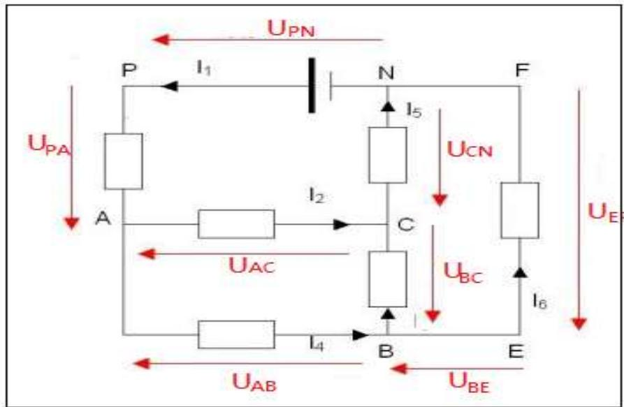
b- Calcul des tensions  $U_{CN}$  ;  $U_{AB}$  ;  $U_{BE}$  et  $U_{EF}$  :
