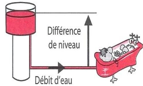
Comme pour l'eau, un courant électrique ne peut circuler que s'il existe une différence dite de potentiel (ddp) entre les deux bornes du générateur.
