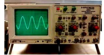
► L'oscilloscope se branche toujours **en dérivation aux bornes** d'un dipôle donc comme un voltmètre, c'est à dire en dérivation du dipôle aux bornes duquel on veut mesurer la tension
