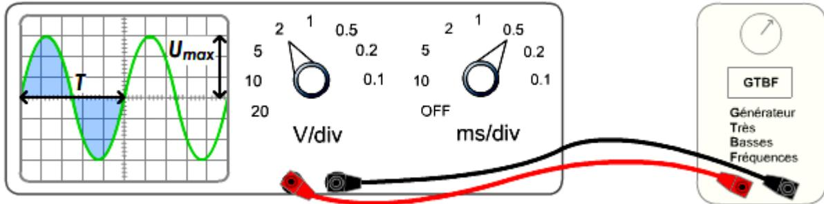
La Période :  $T = S_H \cdot X_T = 0,5 \text{ms/div} \cdot 5 \text{div} = 2,5 \text{ms}$  donc la fréquence  $f = \frac{1}{T} = 400 \text{Hz}$
