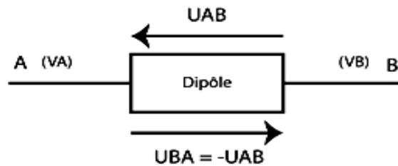
II. Mesure de la tension électrique
