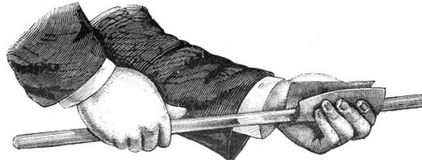
On fait frotter deux bâtons de verre avec un morceau de soie et on rapproche l'une de l'autre (fig.1), et on répète la même expérience en remplaçant le verre par l'ébonite (fig.2).
