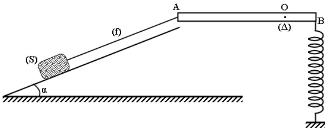
Une tige **AB** de longueur **L**, de masse négligeable et mobile autour d'un axe fixe ( $\Delta$ ) placé au point **O** (perpendiculaire au plan de la figure), tel que  $OB = .4L$
