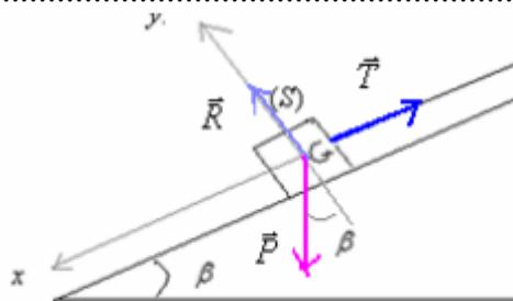
on a:  $\vec{P} + \vec{R} + \vec{T} = \vec{0}$  (1) par projection de la relation (1) sur l'axe Gx:
