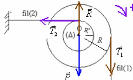
$$\text{Donc: } M_{(\Delta)} \vec{T}_1 + M_{(\Delta)} \vec{T}_2 = 0 \quad \Rightarrow \quad +T_1 \cdot r - T_2 \cdot r' = 0 \text{ avec } r=2 \cdot r' \quad \text{donc: } 2 \cdot T_1 \cdot r' - T_2 \cdot r' = 0 \text{ d'où: } T_2 = 2 \cdot T_1$$
