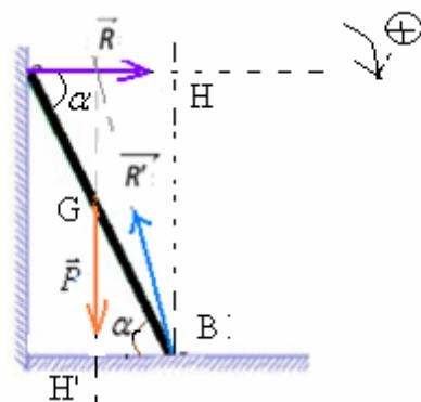
2) En appliquant le théorème des moments par rapport à un axe Δ passant par B et perpendiculaire au plan de la poutre :
