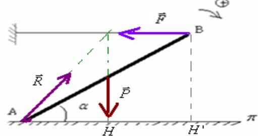
La réaction n'est pas perpendiculaire au plan, donc le contact se fait avec frottement.
