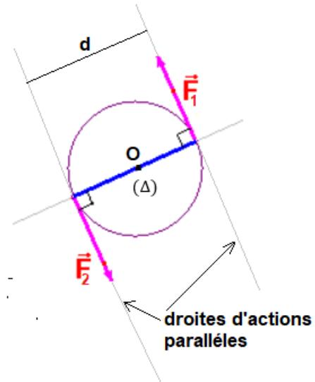
$(\vec{F}_1 ; \vec{F}_2)$  est un couple si  $\begin{cases} \vec{F}_1 + \vec{F}_2 = \vec{0} \\ \vec{F}_1 \text{ et } \vec{F}_2 \text{ ont des droites d'action différentes} \end{cases}$
