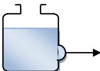
**Conclusion :** Le fluide exerce des forces pressantes de contact sur les parois de la bouteille.
