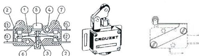
En actionnant le bouton central (5), la lame élastique (1) portant les contacts électriques (2) se déforme. La liaison électrique entre les bornes (11) et (12) est rompue et la liaison entre les bornes électriques (13) et (15) est établie.
