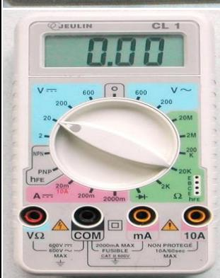
يعطي الفولطметр الرقمي (أو جهاز متعدد القياس) قيمة التوتر مباشرة على الشاشة .
