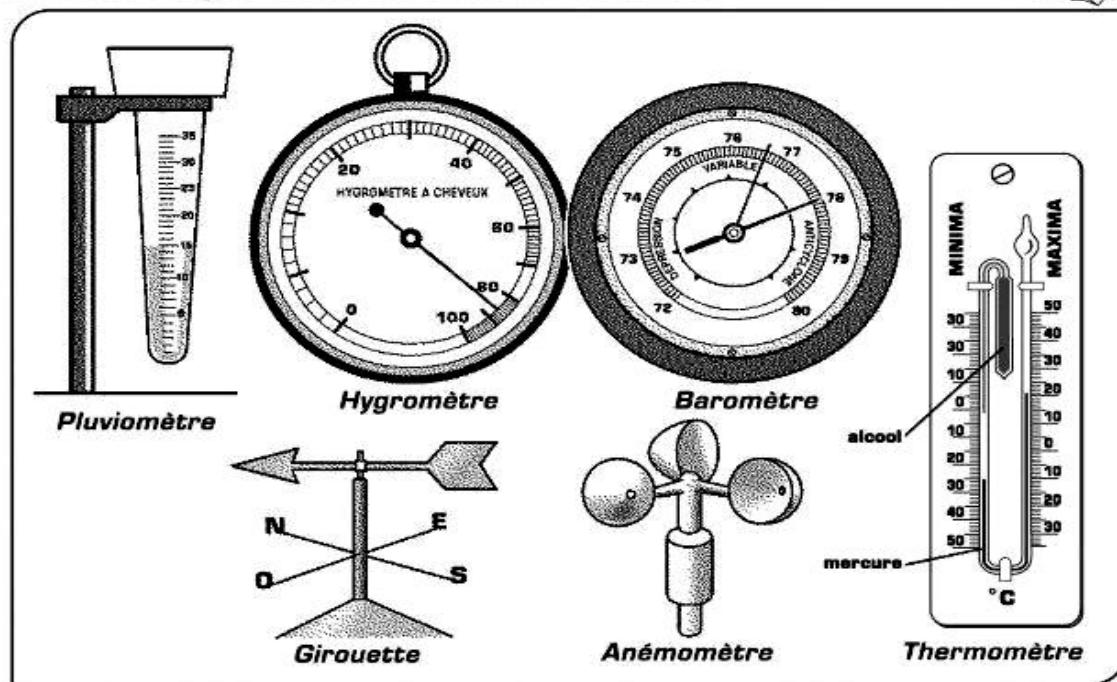
Le pluviomètre mesure le volume de pluie reçu par la surface d'un m<sup>2</sup>
