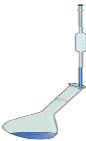
Compléter la fiole jaugée avec de l'eau distillée jusqu'au trait de jauge et agiter en retournant complètement la fiole jaugée pour homogénéiser la solution.
