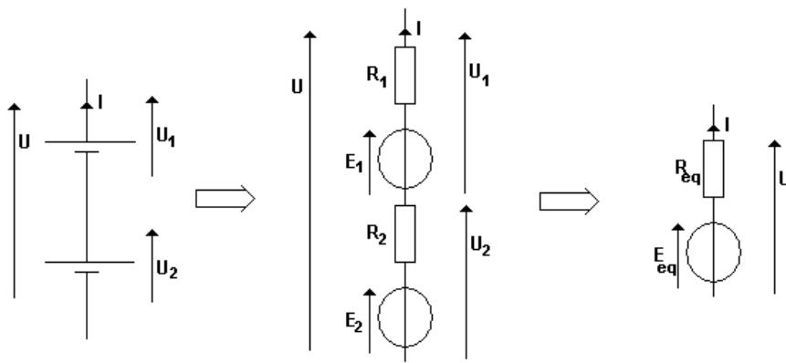
Le premier générateur a pour MET la *f.e.m.* **E<sub>1</sub>** et la résistance interne **R<sub>1</sub>**, le second la *f.e.m.* **E<sub>2</sub>** et la résistance **R<sub>2</sub>**.
