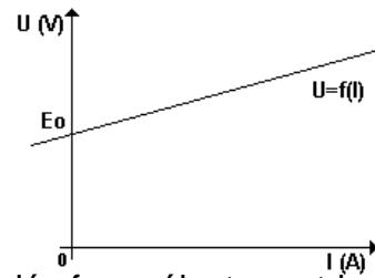
**E<sub>0</sub>** : tension à vide en volts, aussi appelée force électromotrice ou *f.e.m.*
