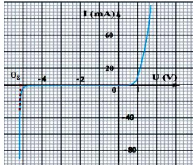
d- **Utilisation :** La diode Zéner est utilisée dans le sens inverse comme régulatrice de tension. La tension obtenue est égale à la tension Zéner.
