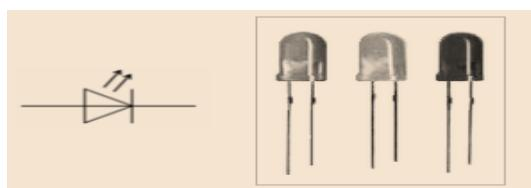
La diode électroluminescente se comporte comme une diode normale et elle émet de la lumière lorsqu'elle est parcourue par un courant électrique.
