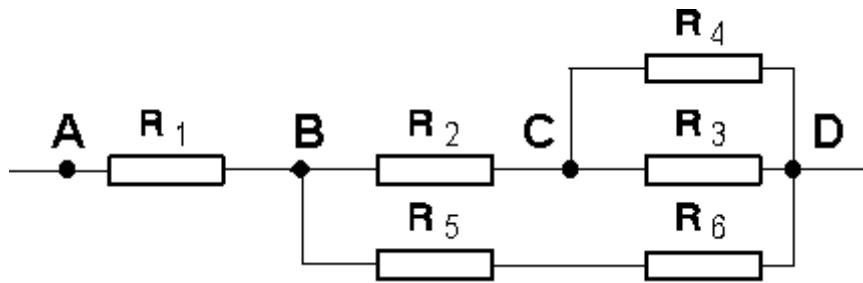
1° Entre B et D il y a deux dipôles en série ; le dipôle équivalent à  $R_5$  et  $R_6$  a pour résistance
