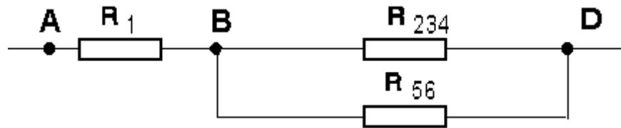
4° Il n'y a maintenant plus de branches ayant des éléments en série ; mais entre B et D, il y a deux dipôles en parallèle ; le dipôle équivalent a pour conductance  $R_{BD} = R_{234} + R_{56}$
