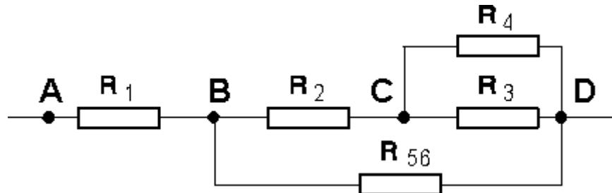
2° Il n'y a maintenant plus de branche ayant des éléments en série ; mais entre C et D, il y a deux dipôles en parallèle ; le dipôle équivalent a pour conductance  $G_{34} = G_3 + G_4$
