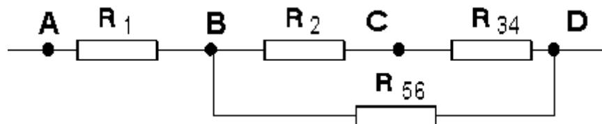
3° Entre B et D il y a maintenant deux dipôles en série ; le dipôle équivalent a pour résistance
