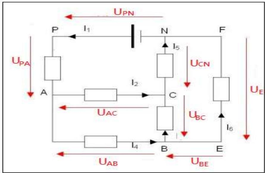
b- Calcul des tensions  $U_{CN}$  ;  $U_{AB}$  ;  $U_{BE}$  et  $U_{EF}$  :
