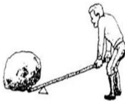
Un rocher, lorsqu'il est soulevé, exercent en A sur le levier une force résistante  $\vec{R}$  d'intensité  $R = 2700\text{N}$  dont la direction est perpendiculaire à celle du levier (voir figure). Le poids du levier est négligeable.
