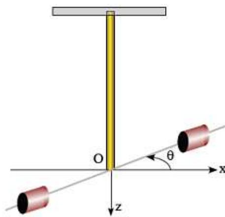
La constante C dite constante de torsion dépend de la longueur et du diamètre du fil (supposé cylindrique) et de la nature du matériau constituant le fil en N.m/rad.
