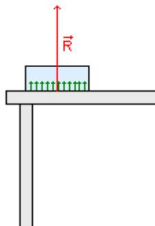
$\vec{R}$  est la réaction de la table sur le livre. C'est une force répartie sur toute la surface de contact.
