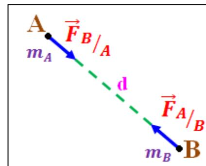
$F_{A/B}$  et  $F_{B/A}$  sont les intensités des forces exprimées en Newton ( $N$ )
