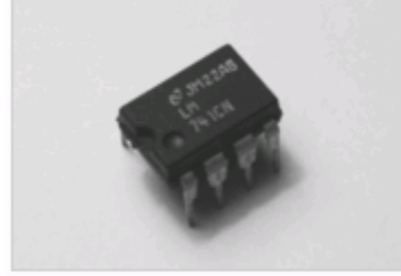
Amplificateur opérationnel LM741 en boîtier DIP8
