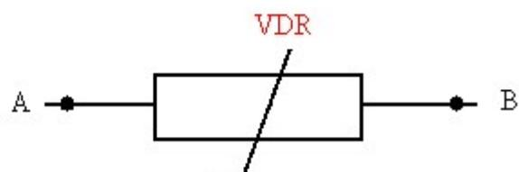
يتكون المركب الكهربائي VDR من حبات شبيه موصلة grains semi conducteur مكتلة بواسطة ملطا Liant و توجد في أغلب الأحيان على شكل قرص أسطواني ملون .
