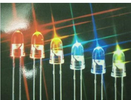
هو ثنائي قطب غير نشيط وغير تماثلي ، لا يسمح بمرور التيار الكهربائي إلا إذا مان مستقطب في المنحى المار شريطة أن يتجاوز التوتر  $U$  بين مربطيه عذبة التوتر  $U$ . في هذه الحالة عند ما يمر فيه التيار الكهربائي ( بعض الميلي أمبيرات ) فإنه يضيء .
