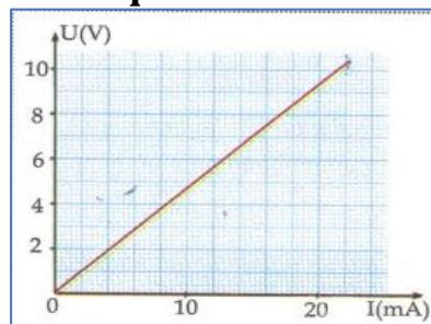
**1. Déterminer graphiquement la tension aux bornes de cette résistance lorsqu'elle est traversée par un courant de 20 mA**
