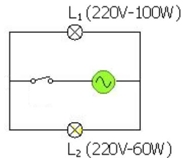
Comparer les éclairements des lampes L<sub>1</sub> et L<sub>2</sub> avec les indications en watt (W) portées sur les culots.
