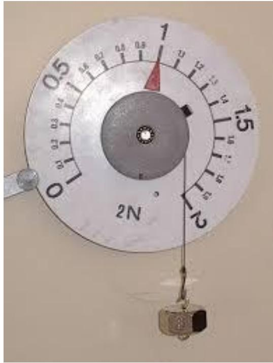
Le dynamomètre indique que l'intensité du poids est  $p=1N$
