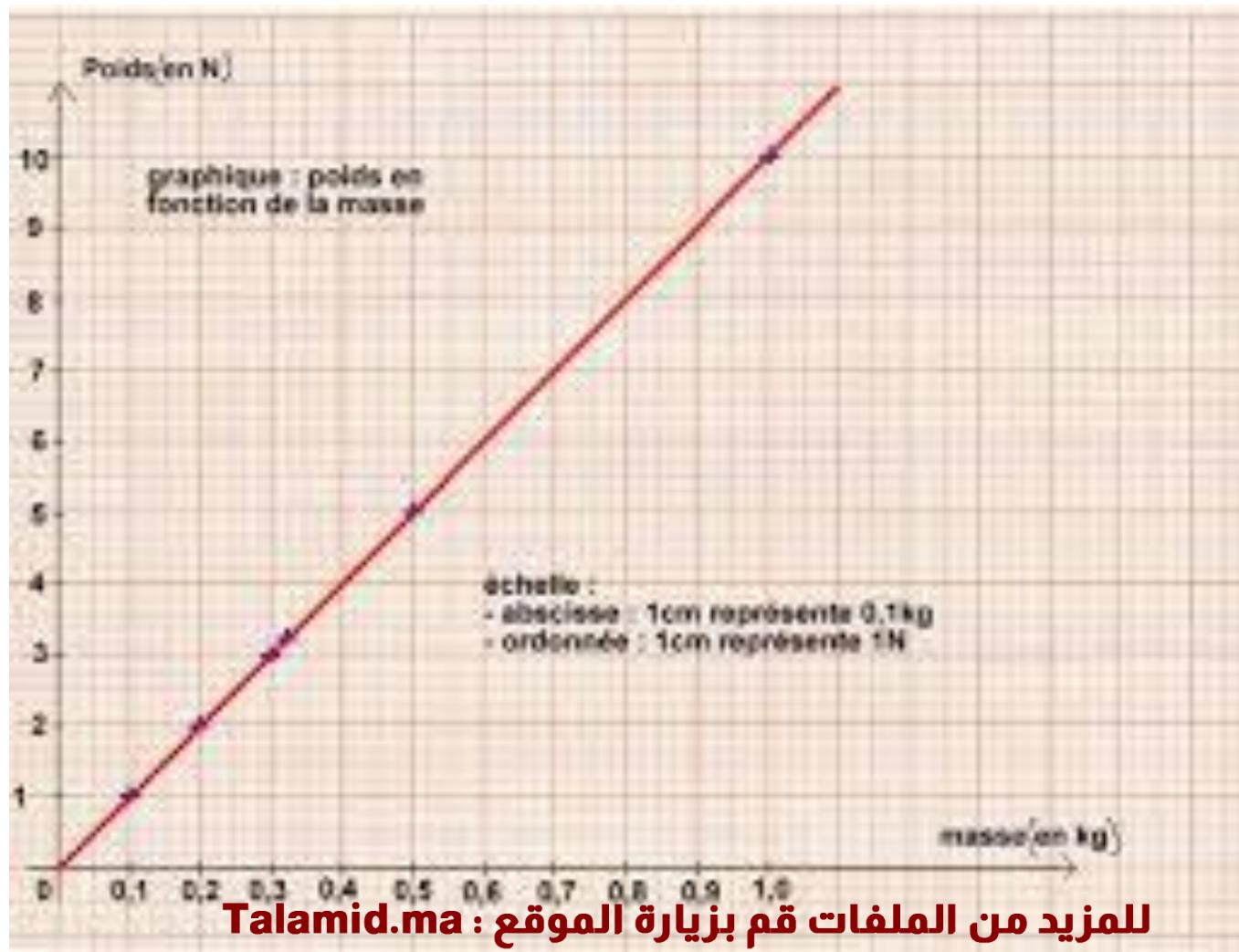
L'allure de la courbe est une droite passant par l'origine des deux axes, donc l'intensité du poids est proportionnelle à la masse.
