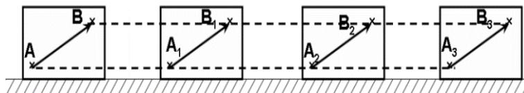
Un solide est en **mouvement de translation** si tout segment reliant deux points quelconques de ce solide **conserve la même direction**, c'est-à-dire lorsqu'il reste parallèle à lui-même au cours du mouvement.
