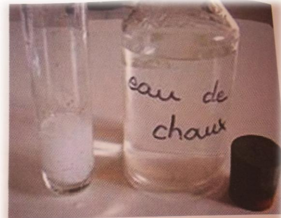
fig.2 : Ajoutons un peu d'eau de chaux dans le tube puis agitons. L'eau de chaux se trouble.
