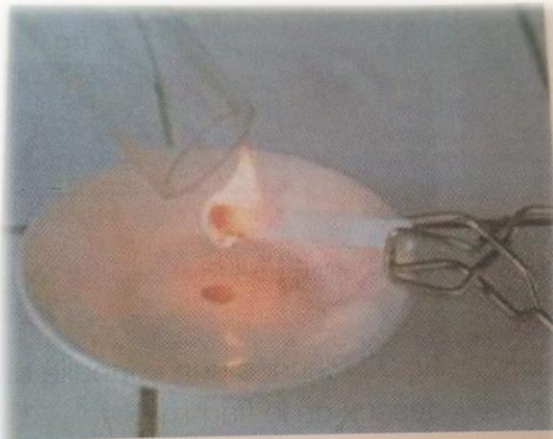
fig.1 : Enflammons un morceau de polyéthylène et plaçons un tube à gaz au dessus de la flamme.
