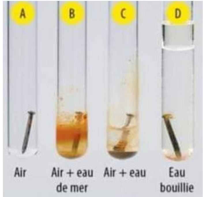
La formation de rouille n'est possible que si le fer est en contact avec de l'air et de l'eau ou plus simplement avec de l'air humide .
