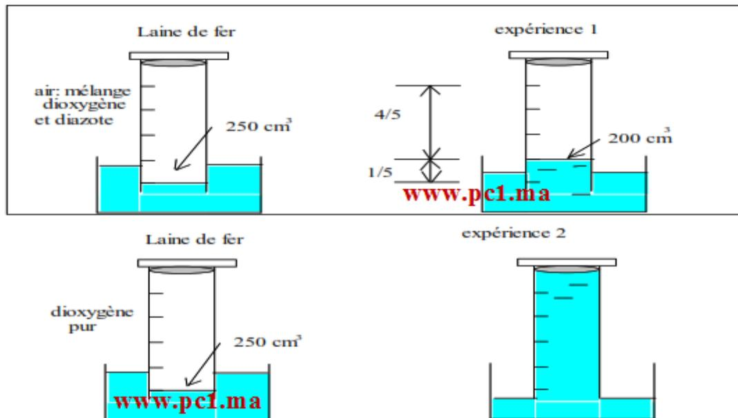
⊘ Dans l'expérience 1 , le niveau de l'eau a monté et occupe un volume de  $50 \text{ cm}^3$  . De plus , le morceau de laine de fer est partiellement rouillé .
