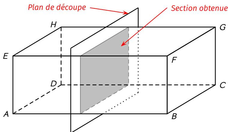
ABCDEF $GH$  est un pavé droit, donc la section par un plan parallèle à  $ADHE$  en grise est un rectangle de même dimension que  $ADHE$ .
