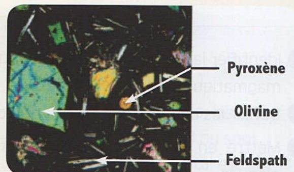
Lame mince du basalte, roche volcanique observée au microscope polarisant
