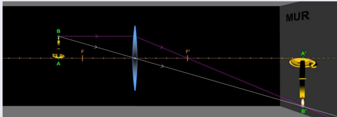
L'image d'un objet obtenu par une lentille convergente
