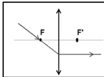
Tout rayon incident passant par le foyer objet principal, émerge de la lentille parallèlement à l'axe optique principal.
