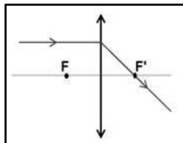
Tout rayon incident parallèle à l'axe optique principal, émerge de la lentille en passant par le foyer image principal.
