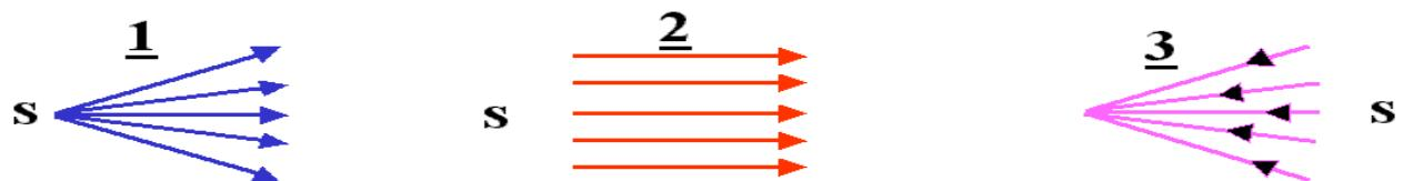
Si les rayons de lumière restent parallèles, le faisceau est cylindrique ou parallèle.
