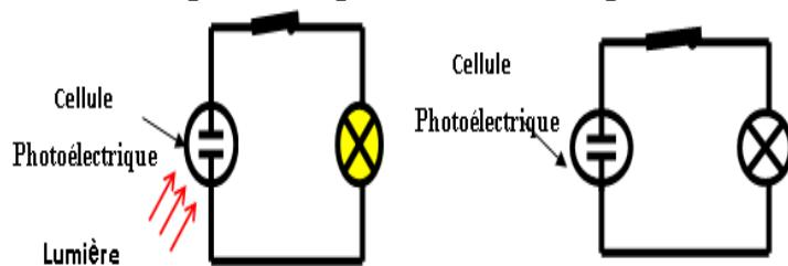
la lampe brille, le courant électrique circule , La cellule photoélectrique produit un courant électrique lorsqu'elle est exposée à des rayons lumineux.
