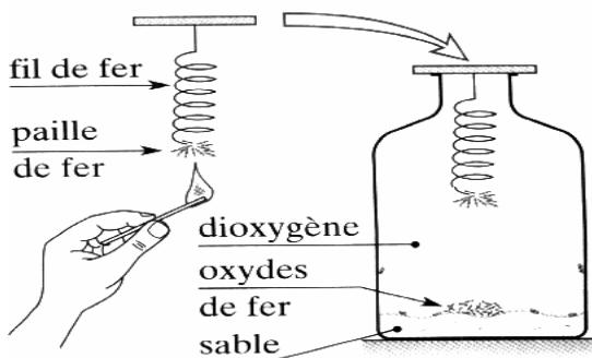
Après avoir amorcé la combustion de la paille de fer dans l'air, on place le fer dans un flacon contenant du dioxygène pur.
