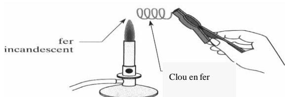
un clou en fer placé dans une flamme devient incandescent mais ne brûle pas. Il se recouvre d'une pellicule noire d'oxyde de fer.
