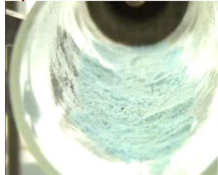
Observation : Le sulfate de cuivre anhydre initialement blanc devient bleu au contact du gaz.
