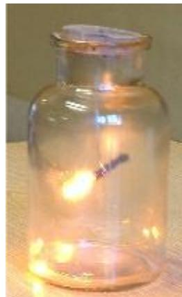
**Observation :** La combustion est beaucoup plus vive que dans l'air. Elle dégage davantage de chaleur et de lumière. La réaction dure plus longtemps.
