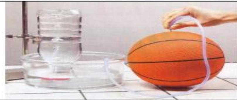
On mesure la masse du ballon après extraction d'un litre d'air.
