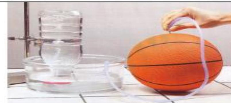
On mesure la masse du ballon après extraction d'un litre d'air.
