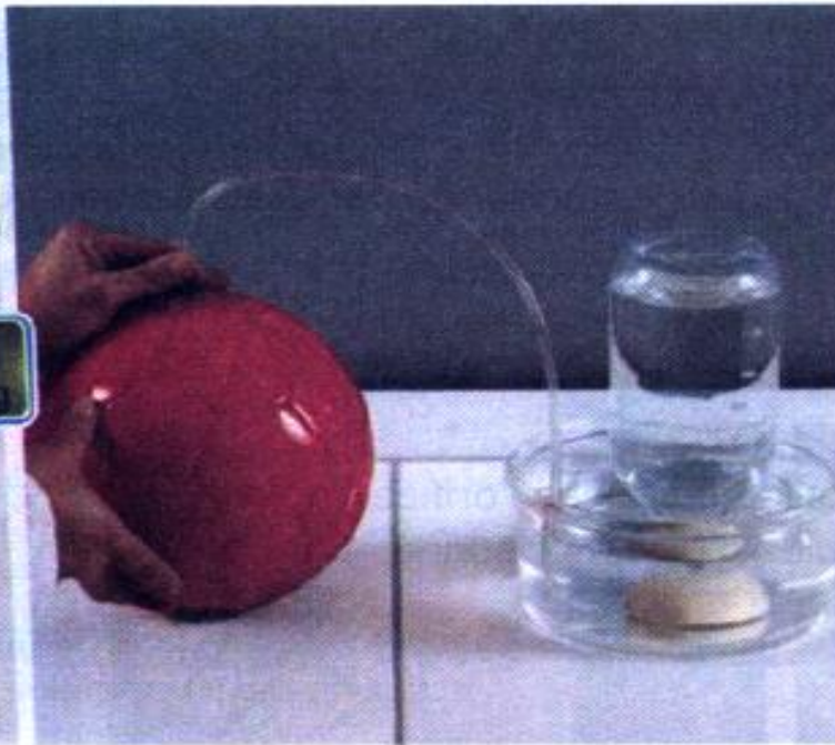
fig.2 : remplissons une bouteille de 1,5 L retournée sur une cuve à eau avec l'air du ballon.
