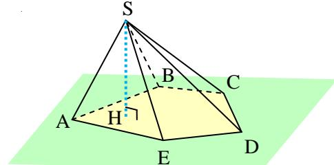
Le point H est le point d'intersection entre le plan de base et la perpendiculaire à ce plan passant par le point S. Le segment [SH] et la longueur SH sont appelés hauteur de la pyramide.
