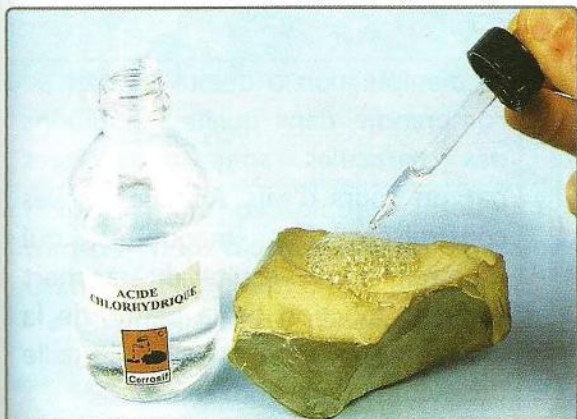
Document 10 : Mise en évidence du calcaire dans une roche. La réaction qui se produit : \text{CaCO}_3 + 2\text{HCl} \rightarrow \text{CaCl}_2 + \text{H}_2\text{O} + \text{CO}_2
