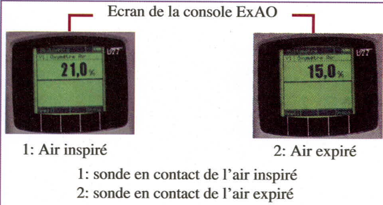
a- Mesure du pourcentage d'oxygène de l'air par un oxymètre*
